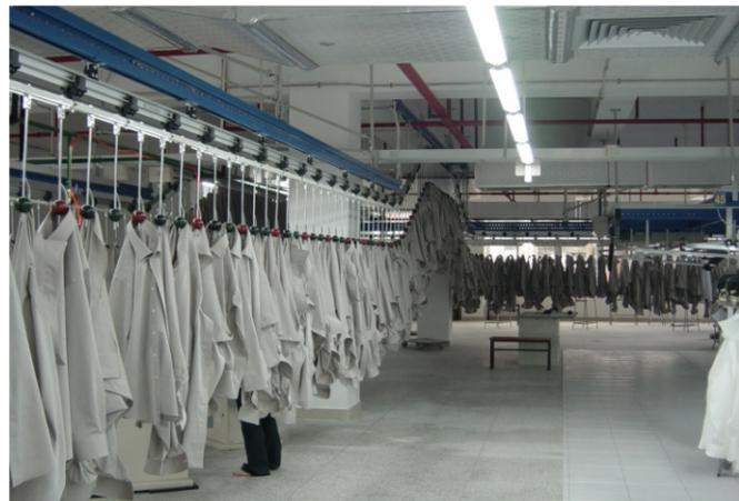
采用718输送系统后，场地的利用效率提高，在高空可以进行输送，提升您厂房的利用率。
